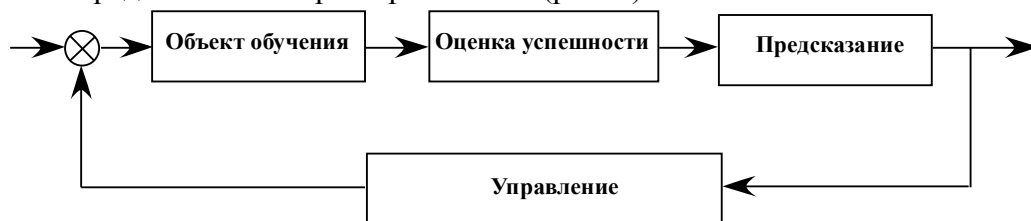
Рисунок 1 – Стандартная схема управления объектом с неопределенными характеристиками
