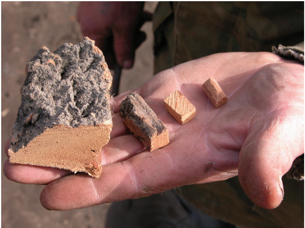
Рис. 6. Шпонки-чопки из пробкового корьевого слоя «тирек» (тополя), устанавливаемые в заготовке лодки-долбенки для контроля одинаковой толщины ее стенок
