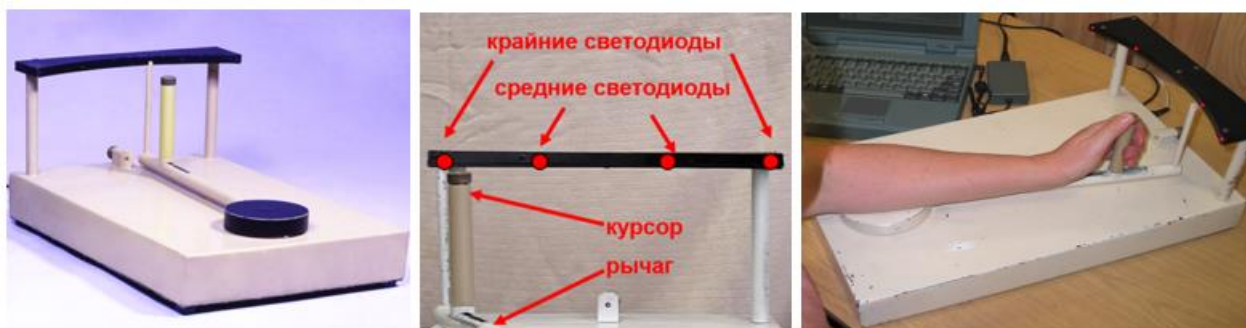
Рис. 1. Внешний вид прибора КИД («компьютерный измеритель движений»), его основные компоненты и положение руки во время тестирования
