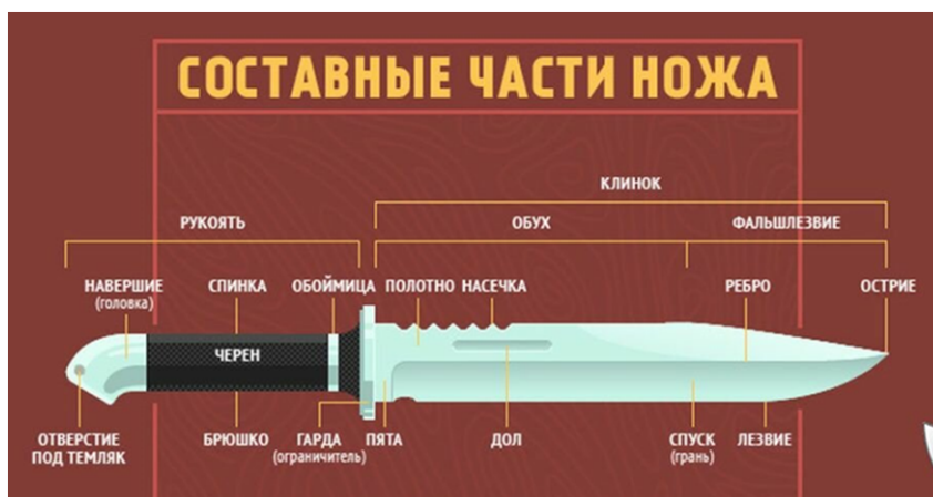
Рис. 1. Составные части ножа
