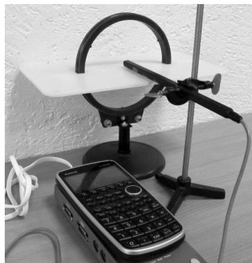
Рис. 1. Калькулятор Casio с датчиком магнитного поля
