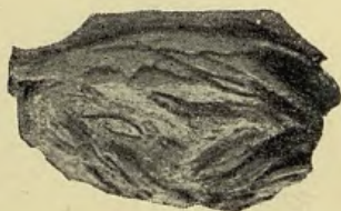
Рис. 2. Боковой разрез слоистой таблетки.
